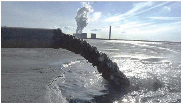
*Рис. 2.4.1-5 Слив суспензии на золоотвал.*
