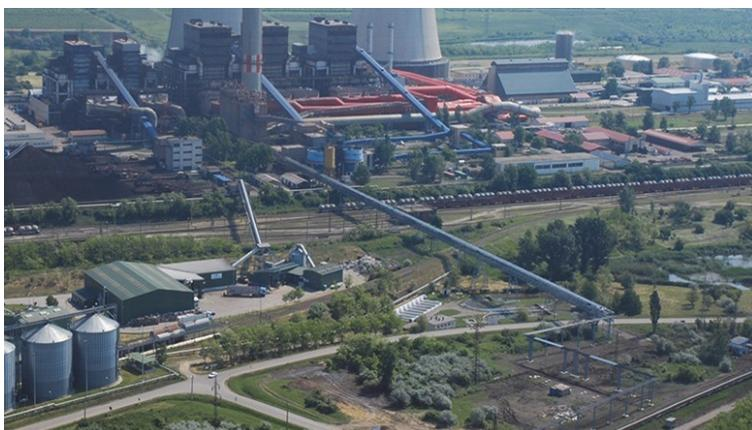
*Рис. 2.4.1-4 Перекачка суспензии на золоотвал*
